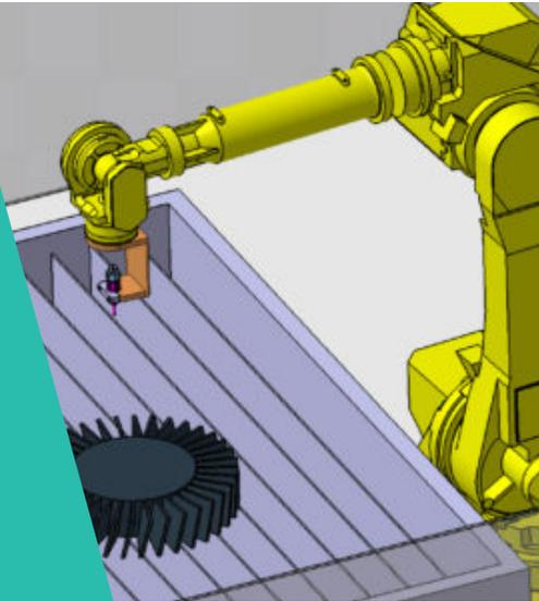
célula robotica de corte por agua y abrasivo con las siguientes características: - Bomba de alta presión de 6000bar del fabricante KMT - Cabezal de agua pura y de agua y abrasivo - Cabezal de doble entrada para corte de materiales compuestos
